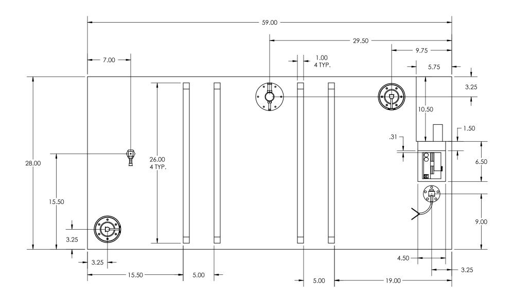
NOTEI: DOGHOUSE IS 6.50 LONG, 4.50 WIDE & 1.75 TALL. RIBS ARE 1.00 WIDE, 1.00 TALL, 1.00 FROM EDGE OF TANK & BEVELLED 45° AT ENDS. Ø1.50 X 2.75 FILL.
