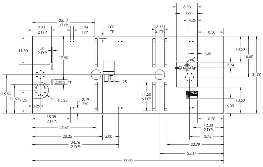
NOTE: CONES ARE  $\emptyset$  4.00 AT TOP AND  $\emptyset$  5.00 AT BOTTOM DOGHOUSE IS 4.50" WIDE X 5.45" LONG X 2.00" HIGH RIBS ARE 1.00" WIDE X 1.00" TALL AND BEVELED 45° AT ENDS
