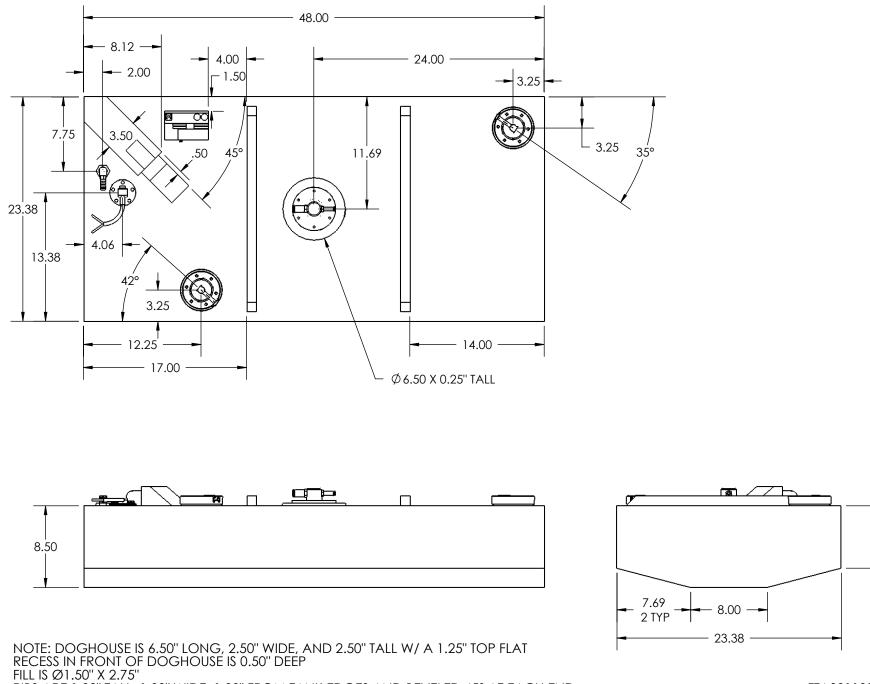
RIBS ARE 1.00" TALL, 1.00" WIDE, 1.00" FROM TANK EDGES AND BEVELED 45° AT EACH END.
